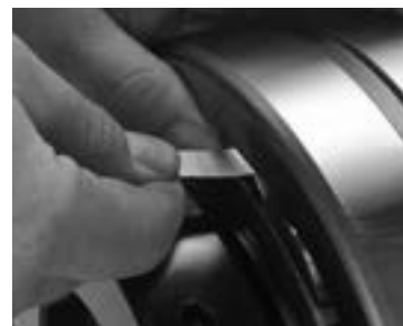
Fig. 18. Mesure du jeu radial interne avant l'installation.
