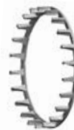
Fig. 7. Cage à ergots en deux parties, usinée en laiton, guidée par la bague intérieure.
