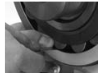
Figure 15. Lors du montage, le jeu interne radial doit être vérifié sur le rouleau déchargé.
