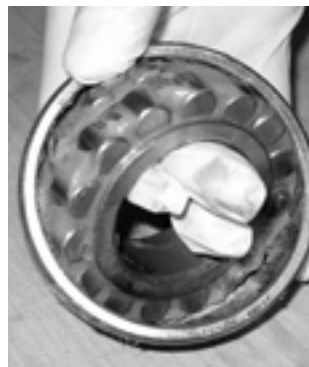
Abb. 21: Schmierfett kann einfach von Hand aufgetragen werden.
