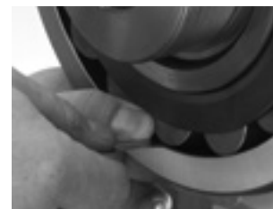
Abb. 15. Während des Einbaus muss das interne Radialspiel (RIC) an den nicht belasteten Rollkörpern überprüft werden.
